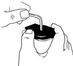
Afloje el tornillo según se muestra. Ajuste a la dirección de escape deseada y apriete el tornillo.
