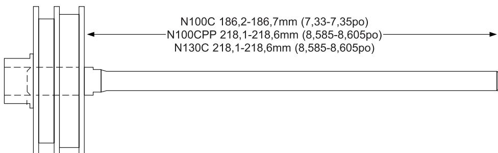
**REMARQUE :** Dans la plupart des utilisations, une usure de 3 mm (1/8 po) de l'enfonceur peut être tolérée. Néanmoins, dans le cas d'une utilisation plus complexe, une usure d'environ 1,5 mm (1/16 po) peut provoquer une légère réduction de la puissance apparente d'enfoncement.
