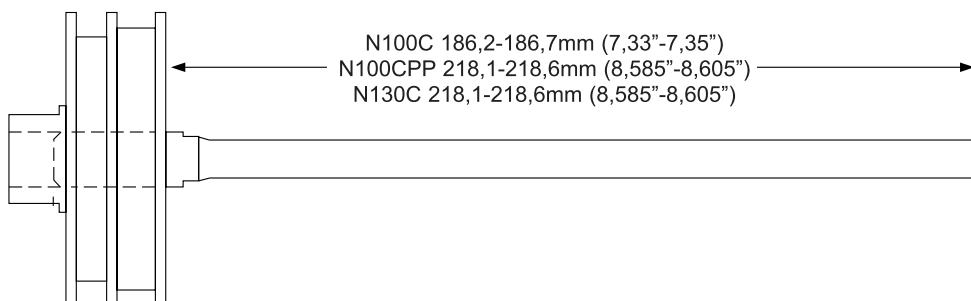
**NOTA:** Un desgaste del impulsor de aproximadamente 3mm (1/8") se puede tolerar para la mayoría de las aplicaciones. Sin embargo, para aplicaciones de impulsión difíciles, un desgaste del impulsor de aproximadamente 1,5 mm (1/16") puede causar una ligera reducción en la potencia de impulsión aparente.
