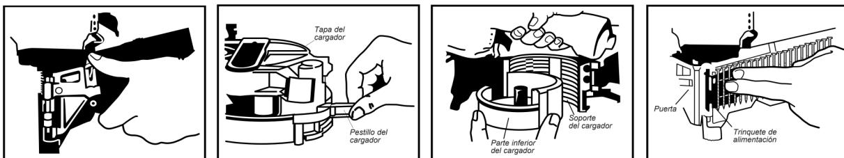
**1) Abra el cargador:** Hale el pestillo de la puerta hacia abajo y gire y abra la puerta. Gire y abra la tapa del cargador.
